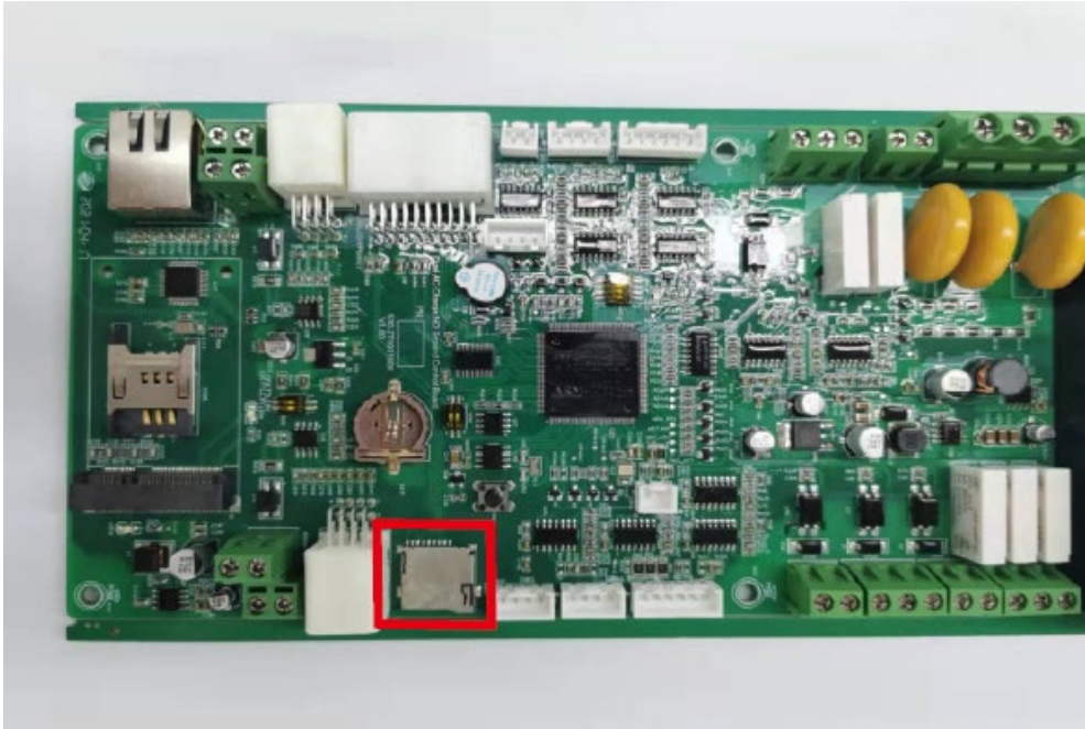
Fente MicroSD du chargeur 22kW
