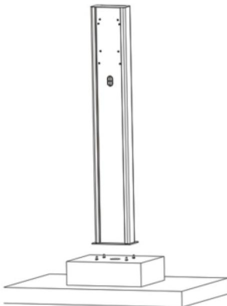
3.2.4 Fixez le support de montage sur le poteau. Positionnez la borne de recharge sur le support et fixez-la sur le support avec les 2 vis.
