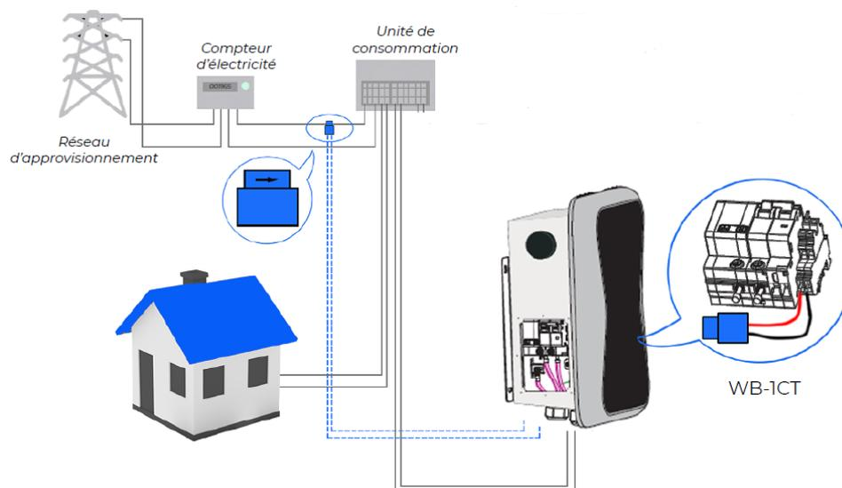
9.2 Si un compteur est utilisé, le câblage sera le suivant :
