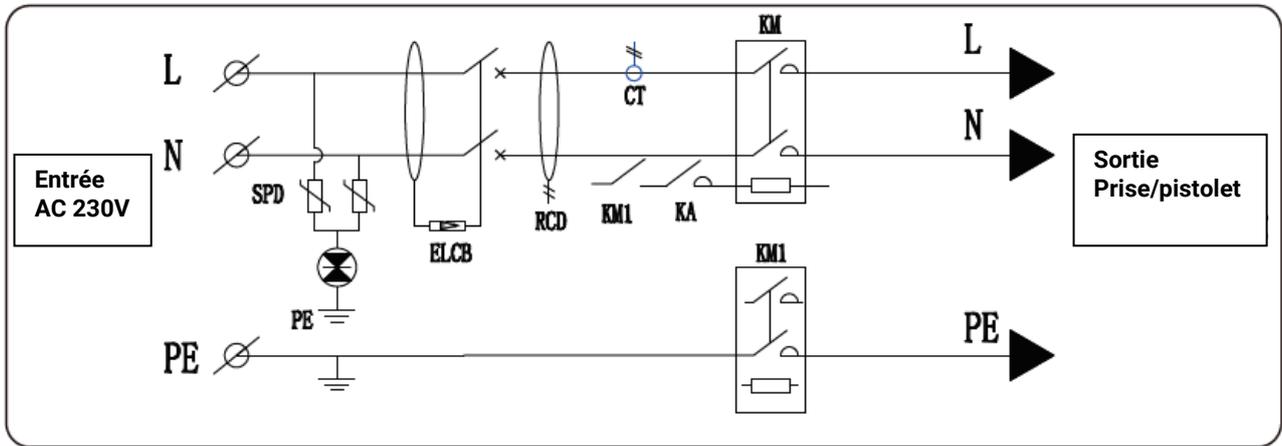
Fig J 1 - J . Schéma du circuit principal
