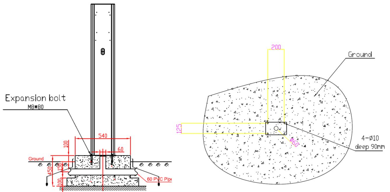
3.2.3 Fixez le poteau sur les trous avec des boulons d'expansion. Les câbles d'entrée doivent entrer dans le poteau à partir de la zone centrale inférieure et le sortir de la zone située sous le crochet du câble.
