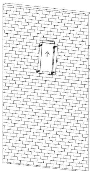
3.1.3 Placez le point de charge sur le support et fixez-le avec les 2 vis en bas du point de charge. L'installation est terminée
