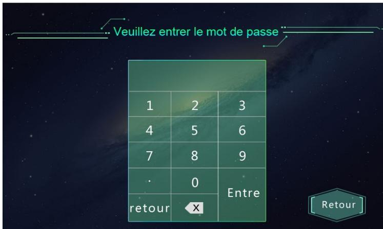
Fenêtre de mot de passe. Avant de saisir une valeur numérique, appuyez d'abord sur le champ d'affichage de texte pour y déplacer le curseur, puis vous pouvez saisir le mot de passe à 4 chiffres. Un mot de passe incorrect n'entraînera aucune réponse ni aucune action.
