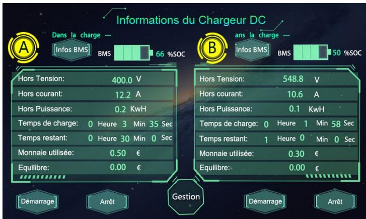
Page d'informations sur la charge, pour vérifier les paramètres de charge en temps réel.
