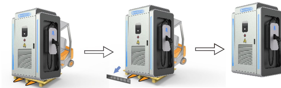
Fig 4.2 .1 Déplacement du chargeur sans emballage
