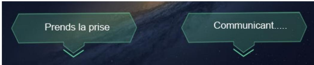
Cette étape indique aux utilisateurs de retirer le pistolet de charge et de le brancher au véhicule électrique. La charge sera lancée automatiquement une fois la connexion établie.
