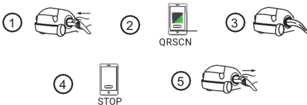
Si vous utilisez l'application WB Charge, la charge peut être démarrée / arrêtée en appuyant sur le bouton ON / OFF de l'application.
