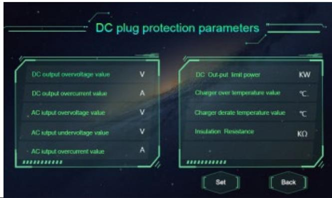
Page des paramètres de protection de DC sortie, utilisée pour définir la valeur limite de tension, courant, puissance, température, etc.
