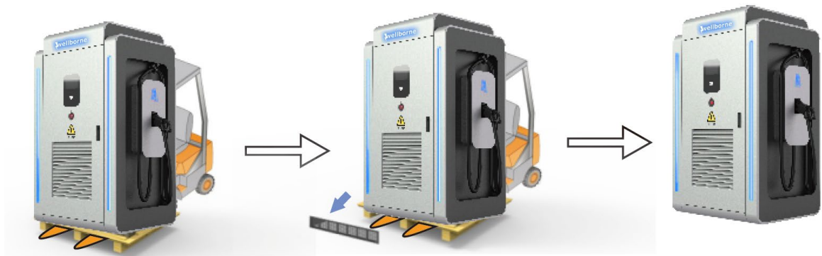
Fig 4.2 .1 Déplacement du chargeur sans emballage
